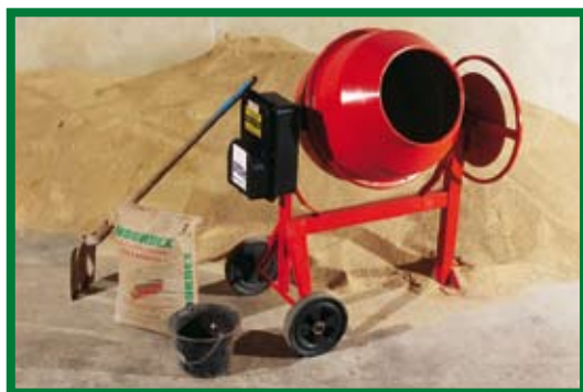
▲ Ensemble du matériel nécessaire à la réalisation du mortier.
